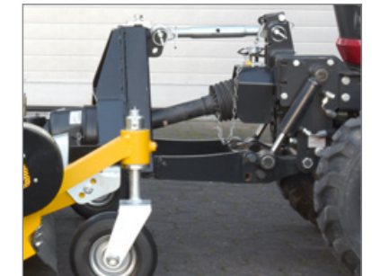
ISEKI, Shibaura, Juhn Deere, Kubota gépekhez való csatlakozóelemekkel és gyorscsatlakozó háromszöggel. További modellek kérésre kaphatók.
