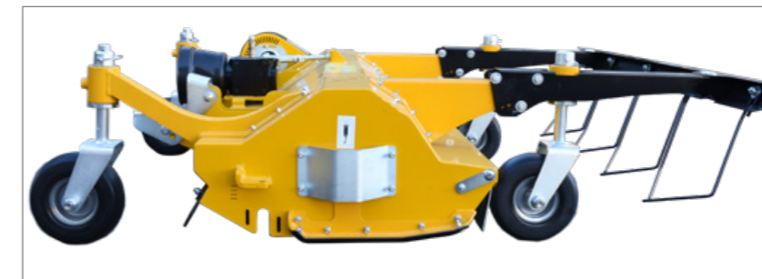
A talaj élővilágának megővése érdekében támasztóhenger helyett szándékosan első és hátsó támasztókerekeket használunk, amelyek nem gyakorolnak nagy felületen nyomást a talajra.
