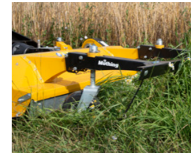
A gép elé szerelt rovarvédő a szériafelszereltség része
