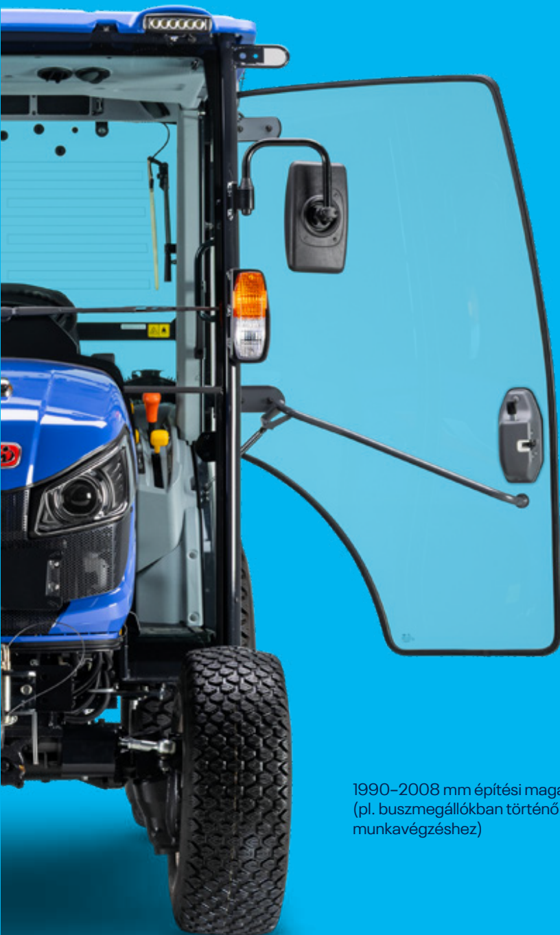
1007 mm-től (speciális gumibronccsal) 1294 mm-ig terjedő külső szélesség. Kompakt méretek járdákon és keskeny utakon történő munkavégzéshez.
